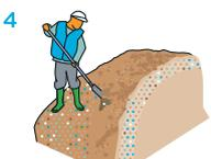
Pour les talus, travailler le sol avec TCU sur une profondeur de 20 cm à l'aide d'une pelle.
